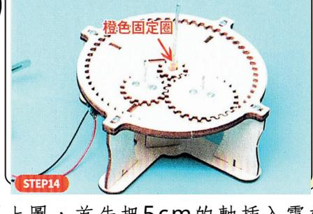
參照上圖，首先把5cm的軸插入電機轉軸上，然後把3cm的軸插入9號板的齒輪上，再然後把1cm的軸插入8號板的齒輪上，最後把橙色固定圈插入5cm的軸上。
