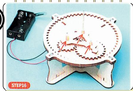
首先把一個橙色固定圈插入1cm軸上，然後把一個橙色固定圈插入5cm軸上，最後把兩個橙色固定圈插入3cm軸上
